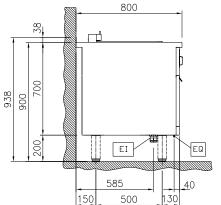
El = Electrical inlet (power) Equipotential screw
